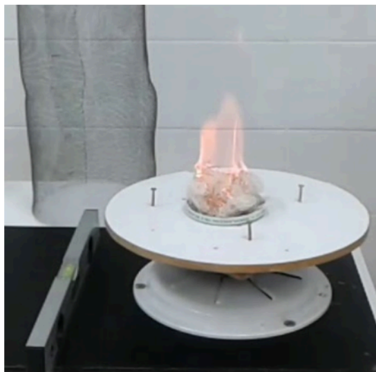
Figura 7: Materiais para construir o tornado de fogo. A base giratória é parte de um ventilador de teto. Fonte: print do vídeo https://www.youtube.com/watch?v=i1PIbZ3PYqU (2017).
