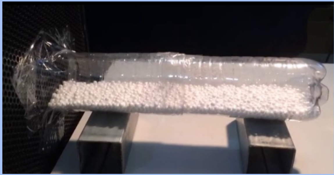
Figura 6: Tubo de Kundt em configurações mais simples com garrafa PET e caixa de som qualquer.
