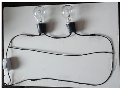
Figura 4: Experimento 1 com uma simulação de um curto-circuito com um fio isolado.
