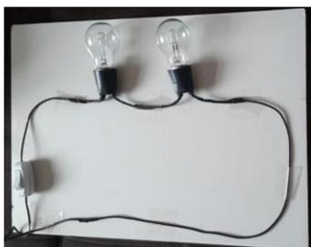
Figura 3: Experimento 1 de um circuito elétrico com duas lâmpadas em série.
