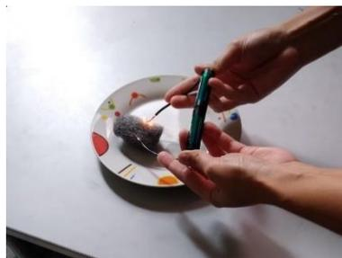
Figura 5: Experimento 2 ilustrando um curto-circuito na esponja de aço.
