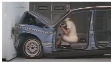
Figura 3: Imagem do caso 3 - uma colisão sem equipamento de segurança. Fonte: os autores
