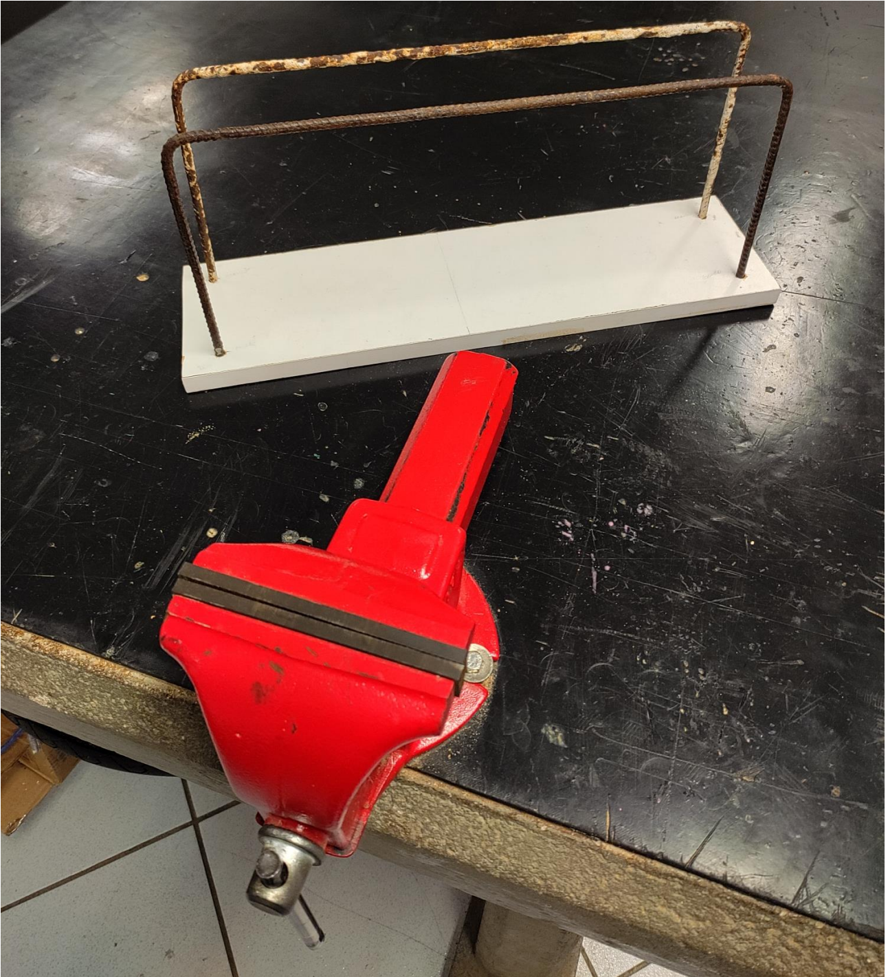
Figura 2 – Base de madeira e suporte de metal encaixados por perfuração no torno de mesa.
