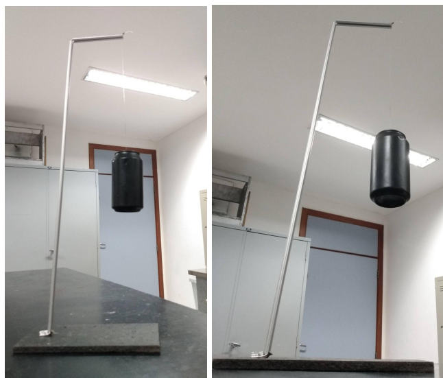
Imagens 2 e 3: Experimento “Máquina de Heron”
